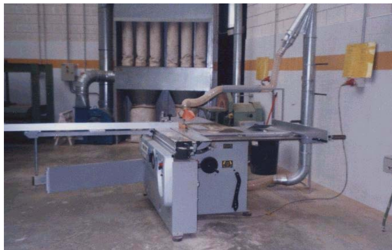
Figura 9. Sierra circular provista de extracción localizada y empujador de piezas
